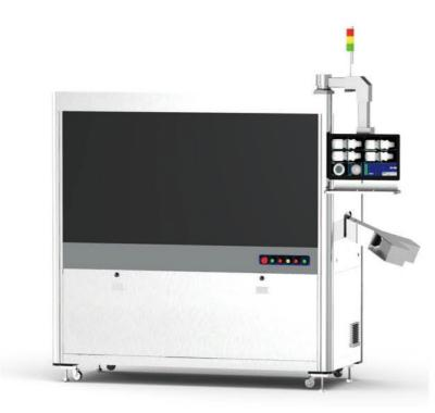
机器型号:TS18-01C-T 瓶体外观视觉检测机
