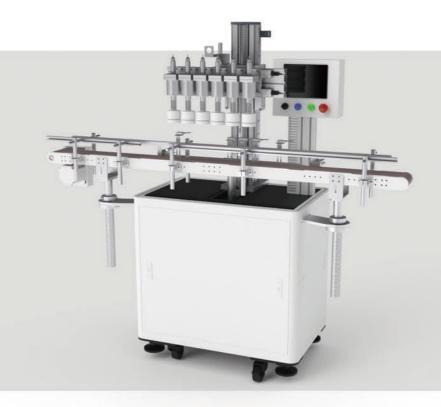
机器型号: TS16-03C-N 多头测漏机
