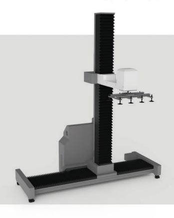
机器型号: TS20-03C 大包堆码机 取包方式:吸咐/夹持
